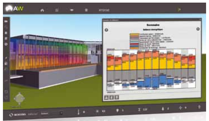
Le bilan énergétique global s'affiche interactivement aux modifications apportées au modèle 3D.
